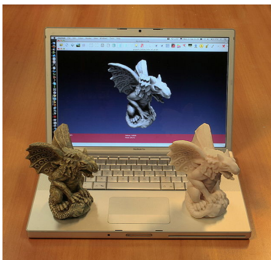
圖 2.26 立體打印機製作的模型
